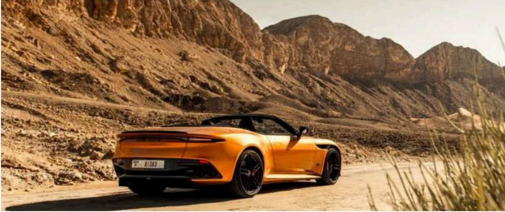
تستفيد مؤخرة السيارة من نظام أيروبليد II الذي يوفر قوة هوائية ضاغطة على الجزء الخلفي من السيارة.
